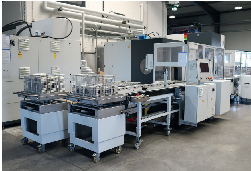
2 Wichtiges Element des effektiven Reinigungsprozesses ist das maßgeschneiderte Transfersystem, das die beiden Reinigungsmaschinen Mafac Palma und Mafac Java zu einer Systemlösung verbindet (© Mafac)
